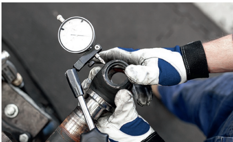
Inspektion der demontierten Gelenkwelle
