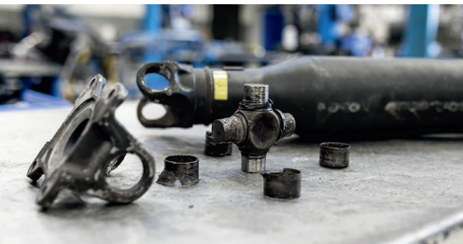
Demontierte Gelenkwelle mit defektem Kreuzgelenk
