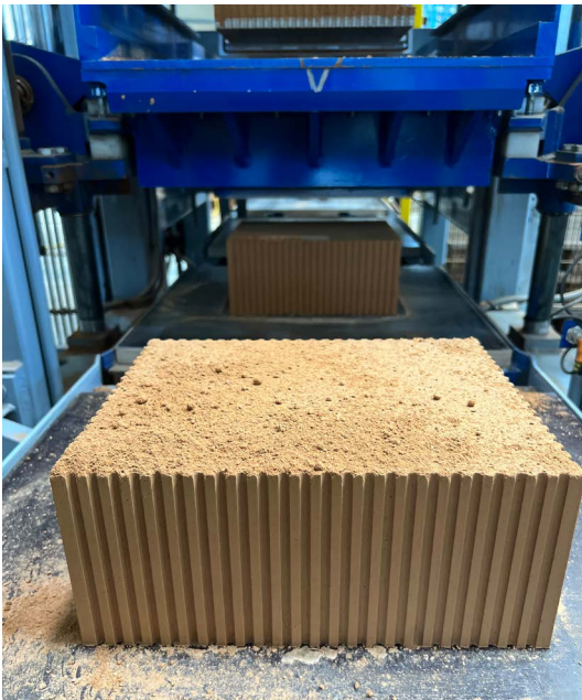
Kaltziegel während und nach dem Pressvorgang
